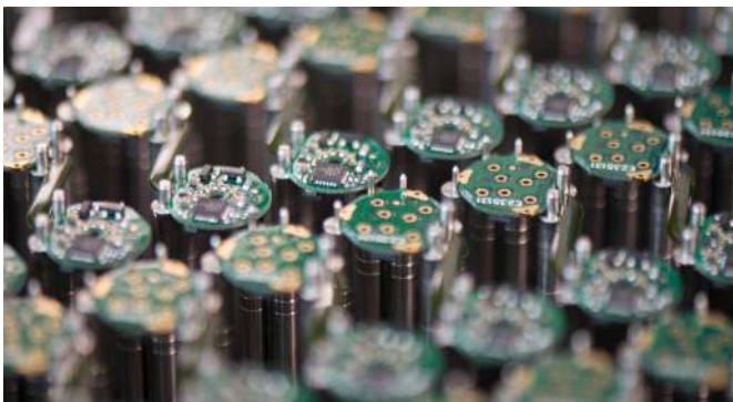
Nutzenfräsen – Ausfräsen der einzelnen Boards mit einer Genauigkeit unter 50 Mikrometern
