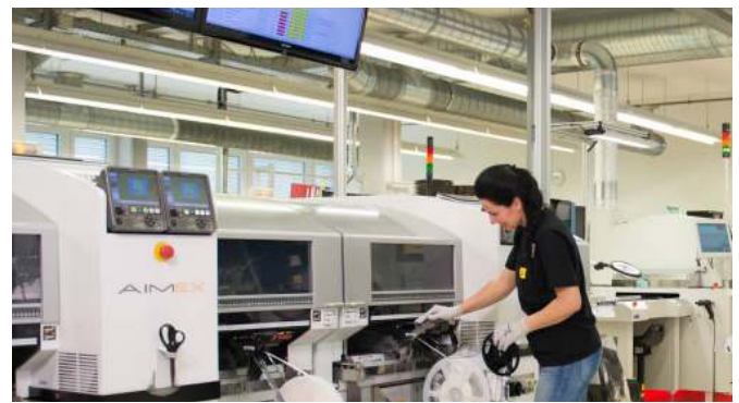
SMD-Bestückung – Bestückung mit bis zu 100 Komponenten pro individuellem Board und einer lateralen Positionierungsgenauigkeit von < 40 Mikrometern
