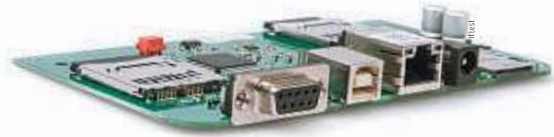
Fiskalspeicher «Loxbox» mit aufbruchgeschütztem Gehäuse (links) und darin enthaltener Elektronik (oben)
