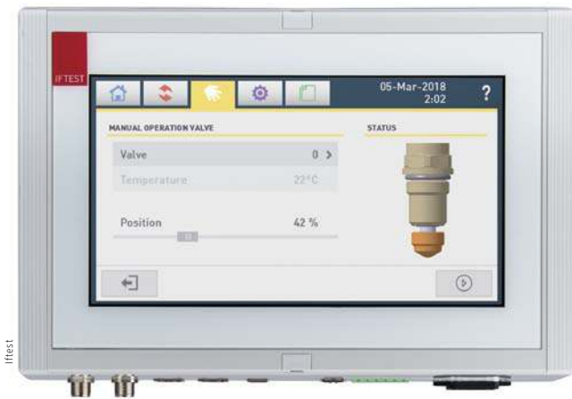
Neues Anzeige- und Bedienmodul mit steckbarem Com-Modul, kundenspezifischem Baseboard und individualisiertem GUI
